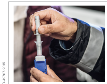
2. Einstecken des Probennehmers in die trichterförmige Öffnung
